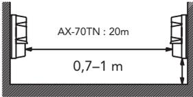
Es wird nicht empfohlen, die Geräte auf diese Weise bzw. in dieser Richtung zu installieren. Bei dieser Installation darf der Erkennungsbereich nur maximal halb so groß sein wie der Originalerkennungsbereich. (Auf diese Weise wird eine Dämpfung des Strahls durch die Kante der Abdeckung vermieden.)
