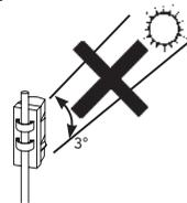
3. Das Gerät nicht an Stellen installieren, an denen Objekte durch den Wind bewegt werden, beispielsweise Wäsche oder Pflanzen, die den Infrarotstrahl unterbrechen können
