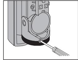
Das Voltmeter auf 5 bis 10 V- einstellen und die Voltmeterprüfspitzen  $\oplus$  und  $\ominus$  an  $\oplus$  und  $\ominus$  der Überwachungsbuchse halten.
