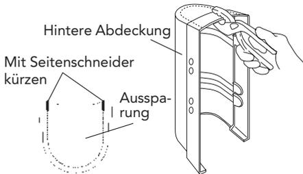
Den Ausschnitt der hinteren Abdeckung mit einem Seitenschneider oder einem ähnlichen Werkzeug entfernen.
