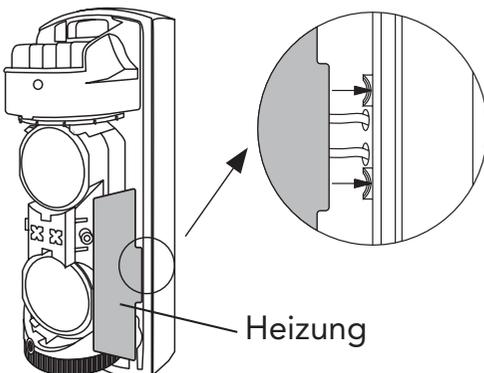
Das Betriebsspannungskabel für die Heizung durch die Kabelöffnung führen, und die Heizung im Gerätesockel einbauen.
