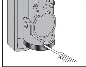
Zur Einstellung des Einstellrädchen für die vertikale Ausrichtung mit einem Schraubenzieher drehen.
