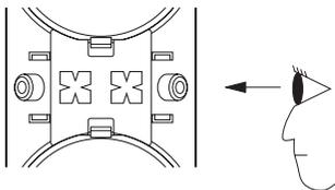
Die optische Achse so ausrichten, dass entsprechend Abschnitt **5-1 Optische Ausrichtung** ein maximaler Empfangspegel gemessen wird. Danach die Funktion wie in **6 Funktionsprüfung** beschrieben prüfen.
