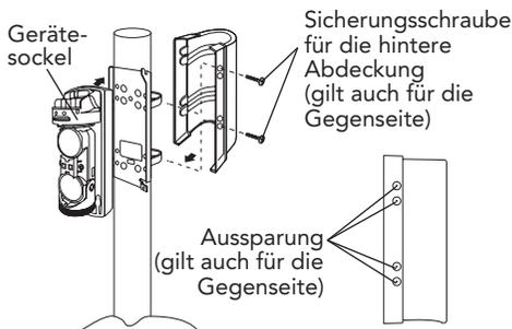
Nach Anbau des Gerätesockels die hintere Abdeckung an der Pfostenhalterung mit den vier Schrauben anbauen.
