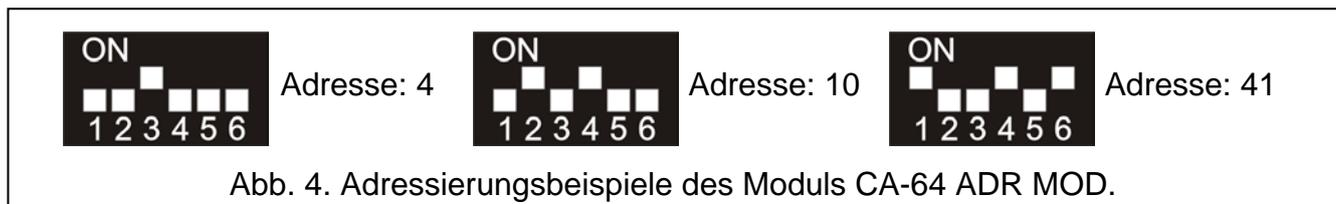
Von der im Modul CA-64 ADR MOD eingestellten Adresse ist die Eingangsnummer abhängig, die dem Melder mit eingebautem Modul zugewiesen wird.
