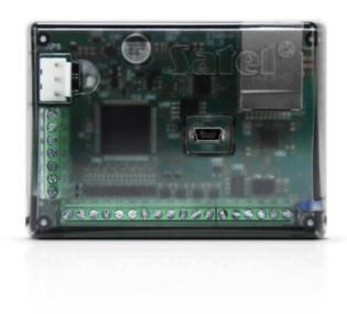
ETHM-A hat 4 Transistorausgänge (OC). Diese können per Fernzugriff gesteuert werden, z. B. über mobile GX CONTROL App, einen Computer mit installiertem Programm GX Soft oder im Rahmen von IoT.
