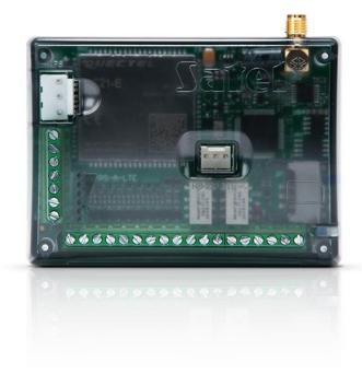
analogen Eingängen oder aus den 1-Wire-Sensoren diese Ereignisse an die Leitstelle weiterleiten oder eine Benachrichtigung an autorisierte Personen senden. Es ist außerdem möglich, eine automatische Änderung des Zustandes von ausgewählten Ausgängen als Reaktion auf bestimmte Ereignisse zu programmieren, z.B. Einschaltung der Heizung bei starkem Temperaturabfall.
