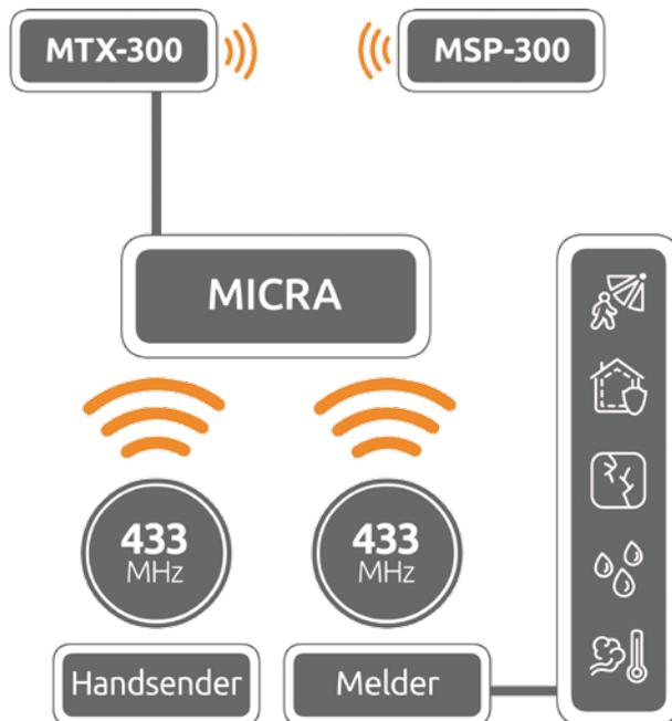
Ebenso kann das MTX-300 bestehende SATEL-Systeme mit Funksirenen oder kostengünstigen Funkmeldern erweitern. Das MTX-300 wird über Steuerausgänge und -eingänge mit dem System verbunden. So ist es möglich, Bestandssysteme mit bis zu 12 Meldern sowie Handsendern zu erweitern.
